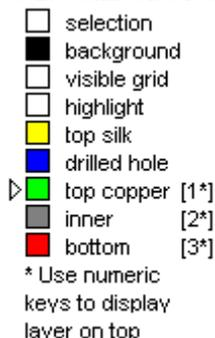
Список слоёв (рис.13) расположен слева от рабочей области редактора корпусов. В этом списке, каждый слой обозначен квадратиком, цвет которого соответствует цвету слоя. Каждый слой отвечает за отображение определённой информации. К сожалению, на цвет и видимость верхних шести слоёв мы не можем влиять. Перечислим эти слои:
