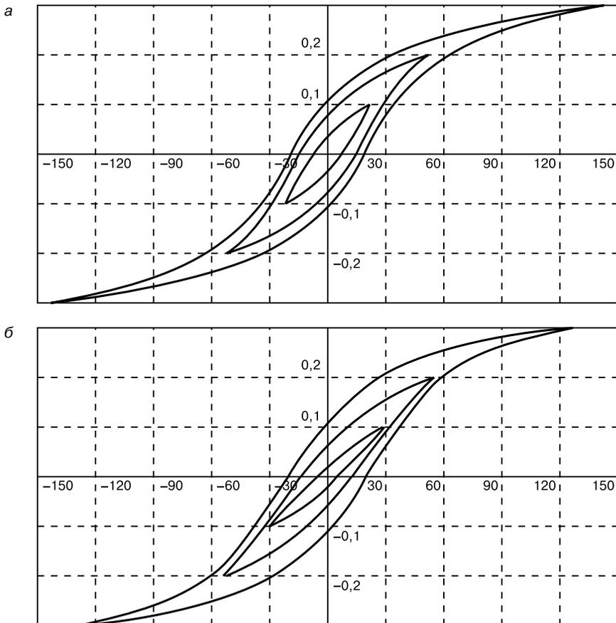
Рис. 3.47 Сравнение результатов моделирования (а) и экспериментального снятия (б) петли гистерезиса феррита M2000HM1
