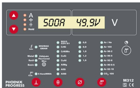
Рис. 32 Дисплей сварочного аппарата PHOENIX PROGRESS
