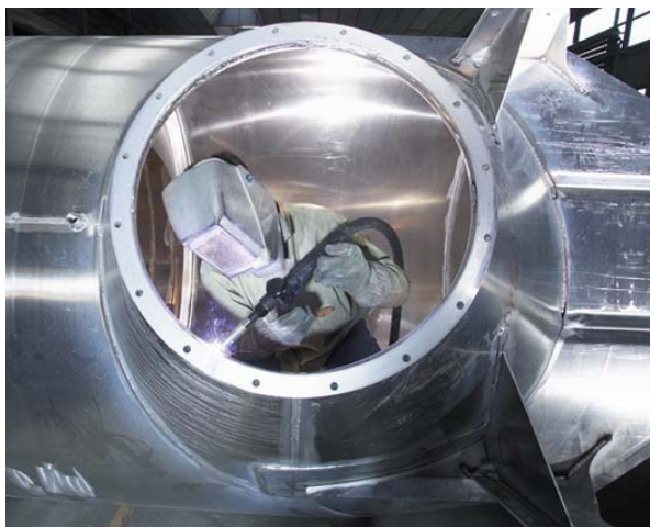
Рис. 42 Сварка МИГ при производстве прицепных цистерн
