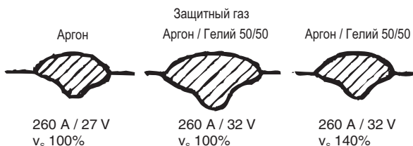
Рис. 40 Профиль провара при разных защитных газах. Материал: AlMg3, Проволочный электрод: Ø1,6 мм
