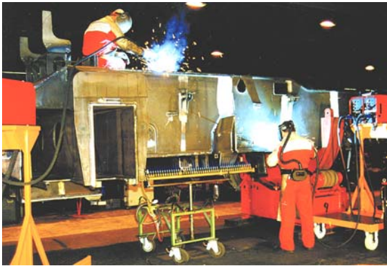
Рис. 3 Сваривание мелкозернистых конструкционных сталей в строительстве кранов
