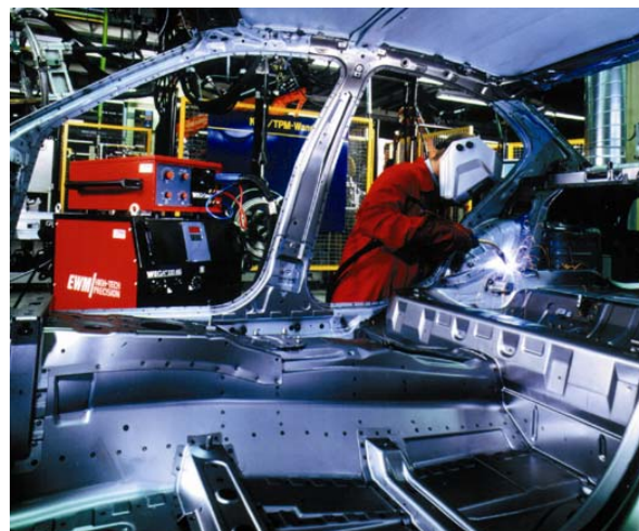
Рис. 41 Пайка МИГ при сборке кузова
