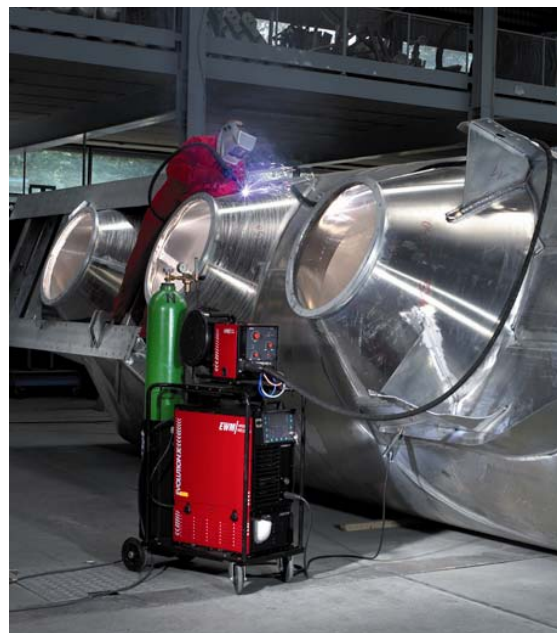
Рис. 39 Сварка МИГ алюминия в автомобильной промышленности
