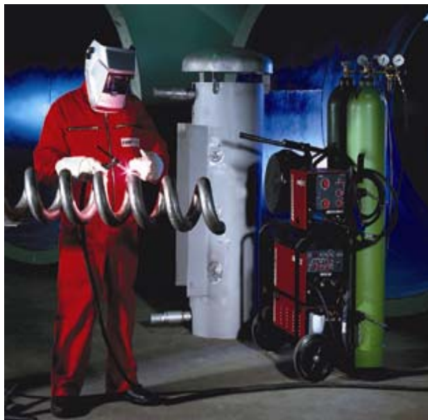
Рис. 1 TRITON 260 DC, Сварка ВИГ, охлаждающий змеевик
