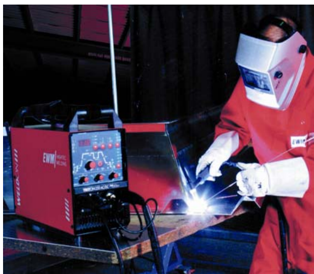
Рис. 27 TRITON 220 AC/DC, инверторный сварочный аппарат для сварки ВИГ
